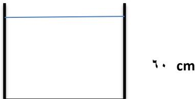
۷- در شکل مقابل فشار مخزن  $12 \text{ kpa}$  از فشار هوا بیشتر است . با باز نمودن دریچه مخزن گاز سطح مایع در هر طرف چند سانتی متر جابجا می شود ؟ (۱/۰ نمره )
