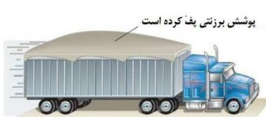
ب) با استفاده از اصل بربولی توضیح دهید چرا وقتی کامیون در حرکت است، پوشش برزنتی آن پف می‌کند؟ (شکل رویه رو)
